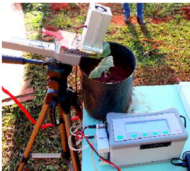
Figura 2. Medidor portátil de fotossíntese, modelo LCI Light Systems (ADC, BioScientific, Herts, England), acoplado a uma fonte de luz LCI (ADC, Bioscientific, Herts, England).
